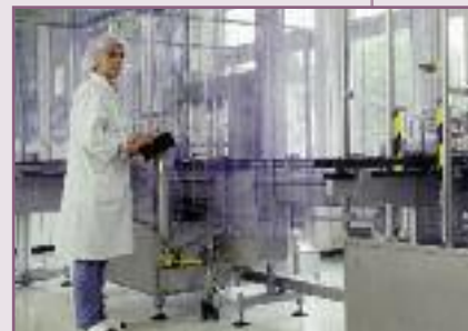
Laminar-Flow Reinluftanlage für Produktschutz zur Abfüllung von pharmazeutischen Erzeugnissen
