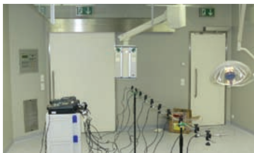
Pomiar laminarności wg normy DIN 1946-4
