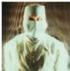
Wizualizacja strugi laminarnego przepływu powietrza
