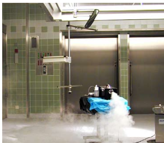
Próby dymowe – z lewej poprawny przepływ laminarny, z prawej brak przepływu
