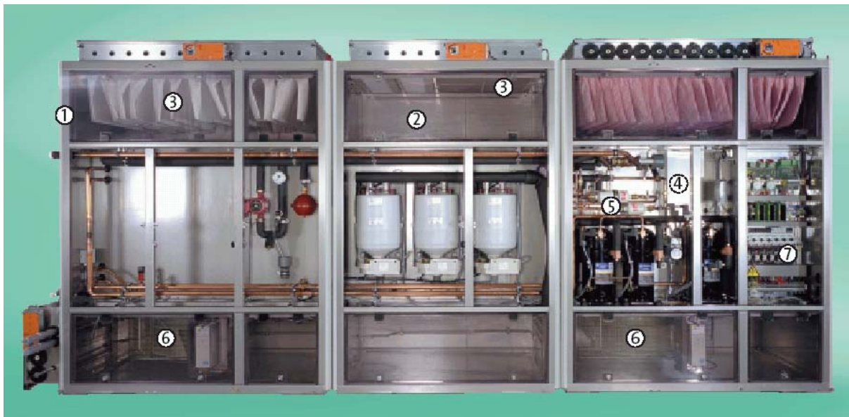
Rys. 6. Modułowa szafa klimatyzacyjna MEDICLEAN firmy Weiss Klimatechnik [1]: 1 - obudowa, 2 - wentylatory, filtry, nawilżacze, 3 - filtry kieszeniowe i kasetowe, 4 - parowniki/wymiennik wody lodowej, 5 - sekcja chłodzenia, 6 - wirniki, 7 - panel przyłączeniowy
